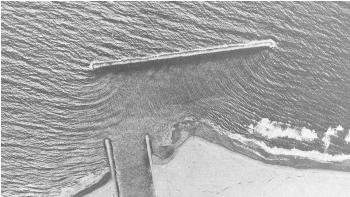
Abb. 6: Diffraktion hinter einem Wellenbrecher (aus: Shore Protektion Manual 1984)
